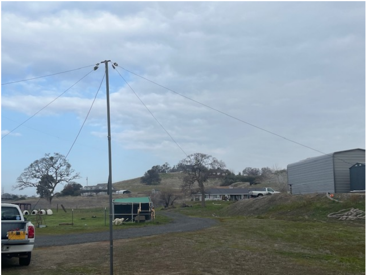
N6AXQ , NVIS Antenna
