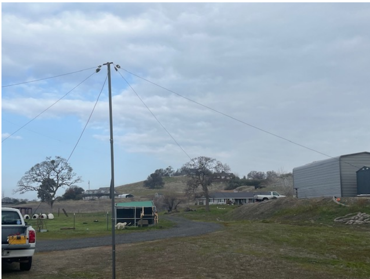
N6AXQ , NVIS Antenna
