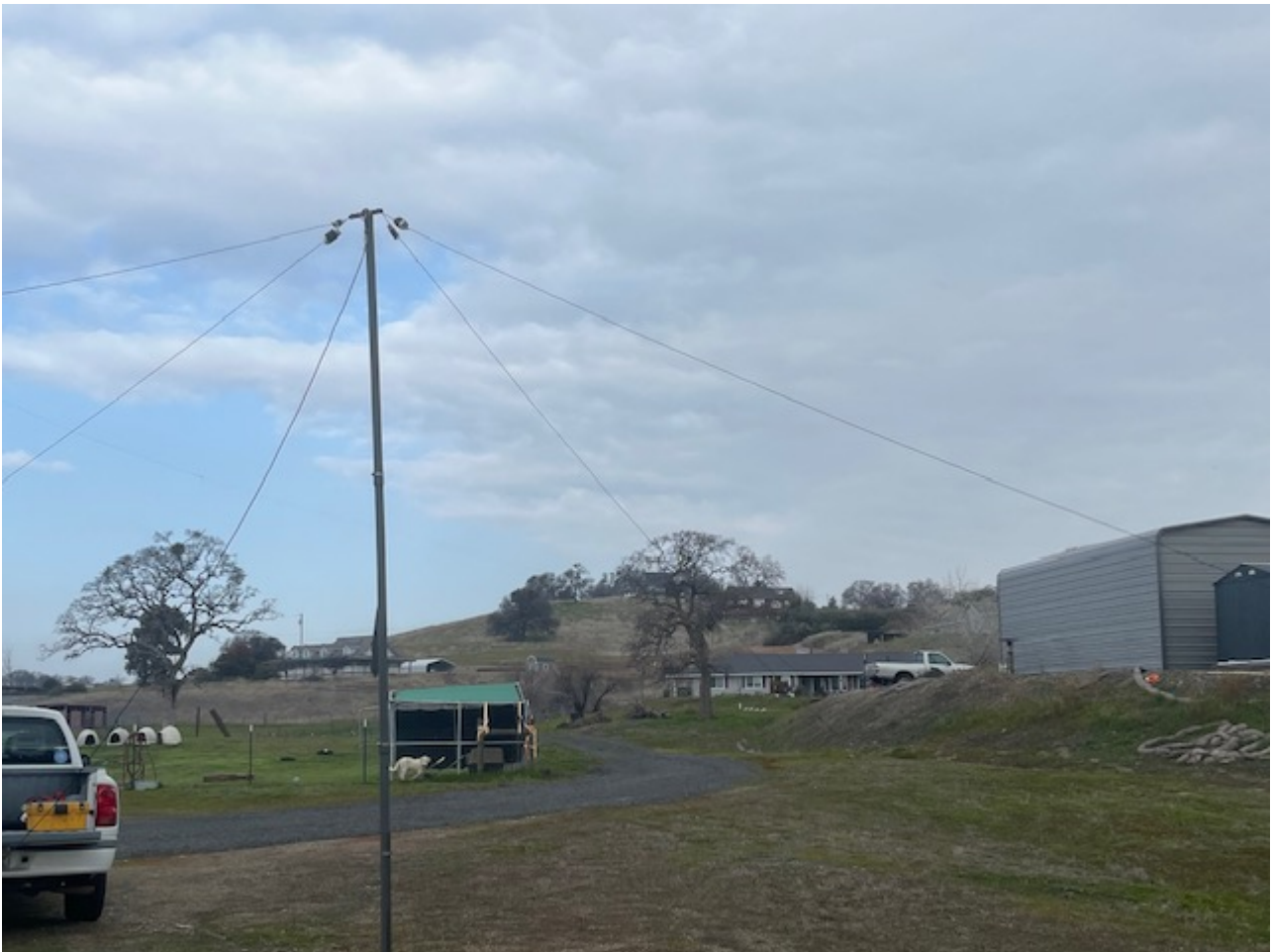
N6AXQ , NVIS Antenna
