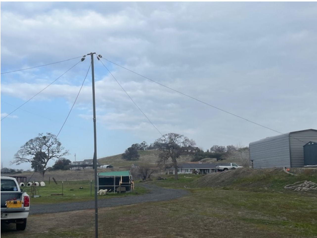
N6AXQ , NVIS Antenna
